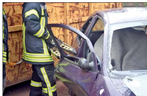
Beim PKW Unfall zur Personenrettung - Tür wird mit Hydraulikspreizer entfernt
